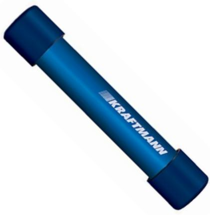
Мембранные осушители незаменимы, если пространство для установки оборудования ограничено или нет источников питания. Достигают точки росы  $-40^{\circ}\text{C}$  и требуют предварительной фильтрации воздуха с использованием фильтров KRAFTMANN серий PF и HF для сохранения мембранны в рабочем состоянии. Серия KMM — вертикального расположения, а серия KMD — горизонтального.
