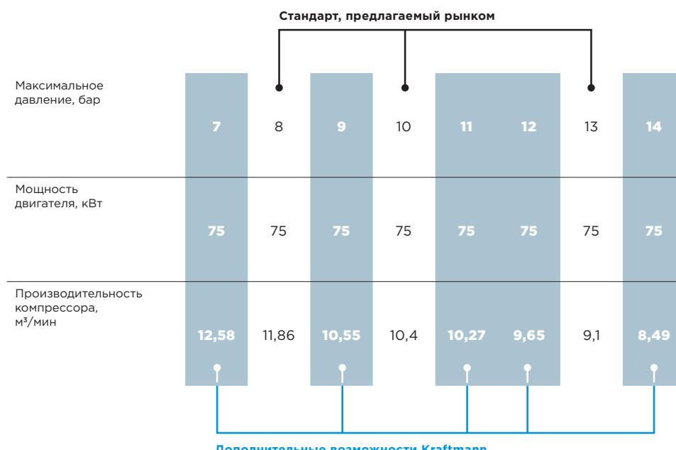
Начиная с модели VEGA 38, Kraftmann предлагает широкий выбор моделей с максимальным давлением компрессора с шагом в 1 бар, в то время как стандартный рынок компрессоров с ременным приводом ограничен узким диапазоном.
