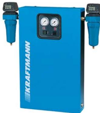
Адсорбционные осушители холодной регенерации серии ADS привлекают компактным дизайном и простотой обслуживания. Подходят для настенного монтажа, укомплектованы фильтрами предварительной и дополнительной очистки. В зависимости от выбранного времени цикла осушки достигают точки росы -40 °C или -70 °C.
