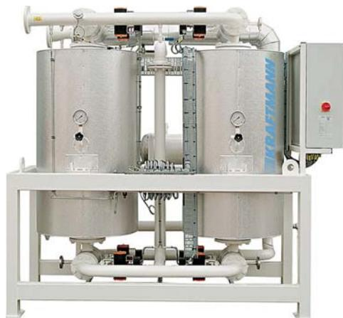
Специальная версия осушителей, в которых для десорбирования насыщенного влагой сушильного агента используется теплота сжатого воздуха. Установки КНС применяются везде, где воздух сжимается безмасляными компрессорами и на выходе имеет высокую температуру. Достигают точки росы -25 °C.
