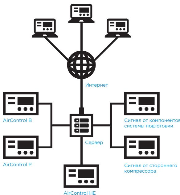
Интеллектуальные системы управления способствуют эффективному управлению компрессорами, выполняя все функции контроля и протоколирования. Это имеет большое значение для снижения затрат, повышения доступности и эксплуатационной безопасности как отдельных компрессоров, так и сети компрессоров.
