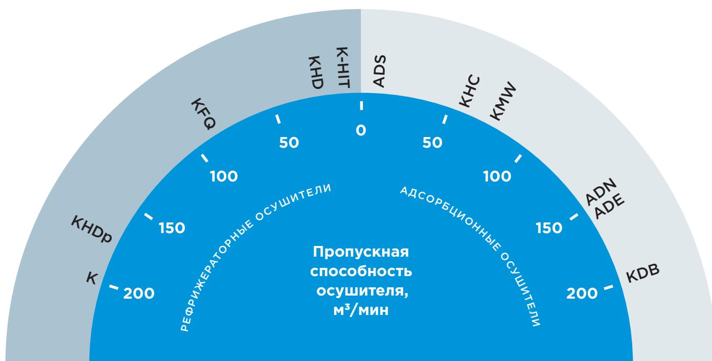
**Одним из основных параметров осушителя является его пропускная способность.** В таблицах параметров приведены показатели пропускной способности осушителей при давление 7 бар и температуре сжатого воздуха 35 °C. Если условия работы осушителя отличаются от стандартных, то пропускная способность осушителя будет скорректирована.
