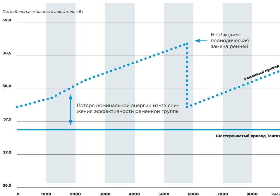
Конструкция привода обладает высокими эксплуатационными характеристиками. КПД составляет более 98%.
